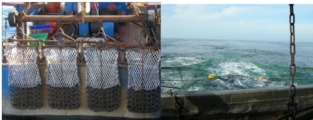
Figure 12 : Illustration des dragues à coquille Saint-Jacques (à gauche) et du chalut pélagique (à droite)
